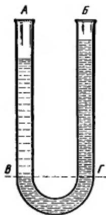
1. В изогнутую стеклянную трубку в одно колено налит вода, а в другое — спирт
